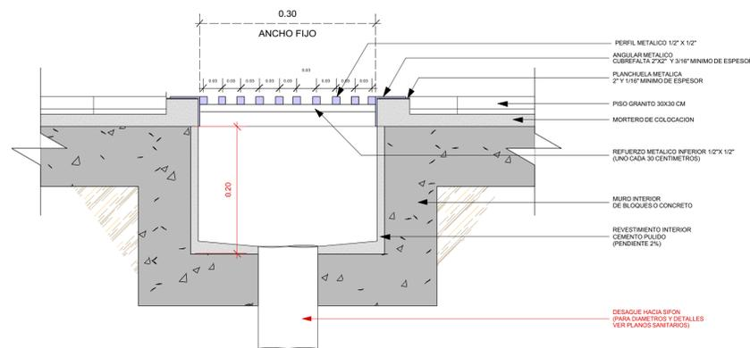
1 DETALLE ARQ. SECCION TRANSVERSAL DE REJILLA EN PISO COCINA
